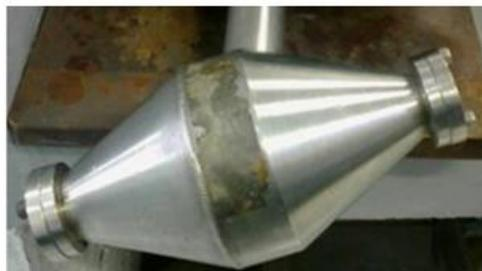
Figura 21 - Misturador de cargas dos pós
