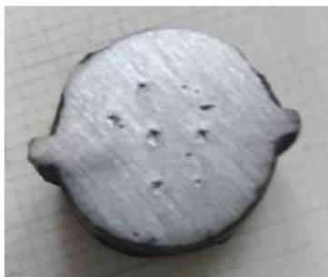
Figura 57 - Na face seccionada, feito medições de dureza
