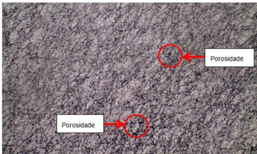
Figura 54 - Porosidade sem ataque químico Nital, com aumento de 100x
