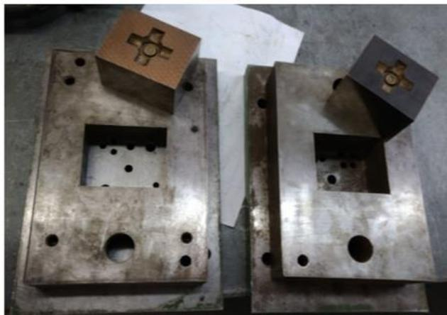
Figura 48 - Bases superior e inferior furadas na fresadora, cortadas na eletroerosão a fio unidas
