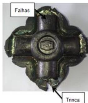
Figura 63 - Trincas na rebarba
